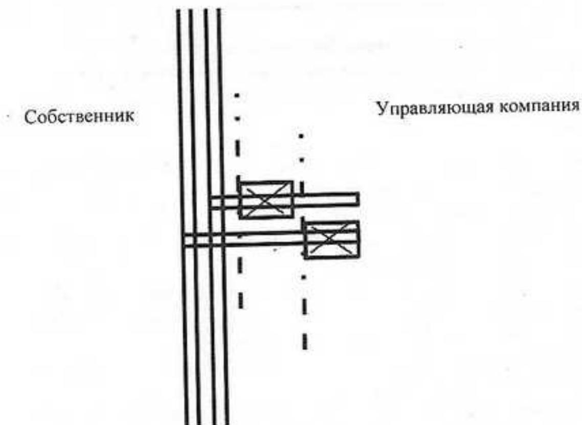
Первые запорно-регулирующие краны на отводах внутриквартирной разводки от транзитного стояка горячего и холодного водоснабжения. Транзитный стояк обслуживание Управляющая компания, систему после точки разделения от первого вентиля на стояке, либо от первого сварного соединения - Собственник.
