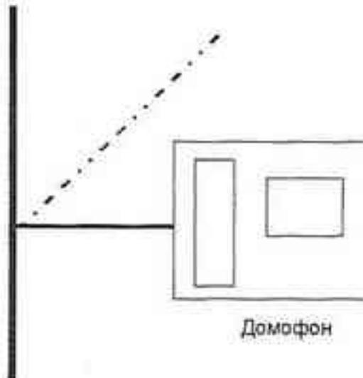
Точка присоединения квартирного кабеля к общедомовому кабелю. Разводку кабеля по дому обслуживает Подрядная компания, остальное - Собственник.
