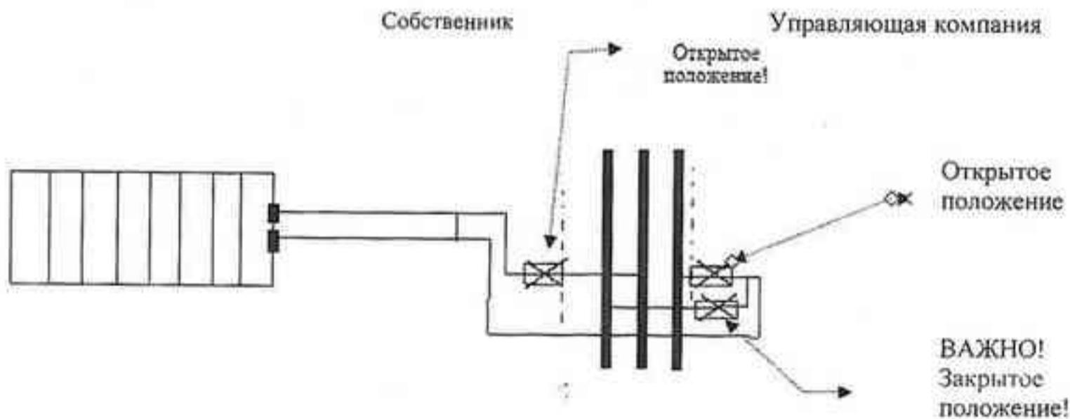
Первые точки присоединения подводящих и отводящих трубопроводов системы отопления. При отсутствии вентилей - по первым сварным соединениям на стояках. Подводящие и отводящие трубопроводы до точек присоединения обслуживает Управляющая компания, остающаяся часть - Собственник.
