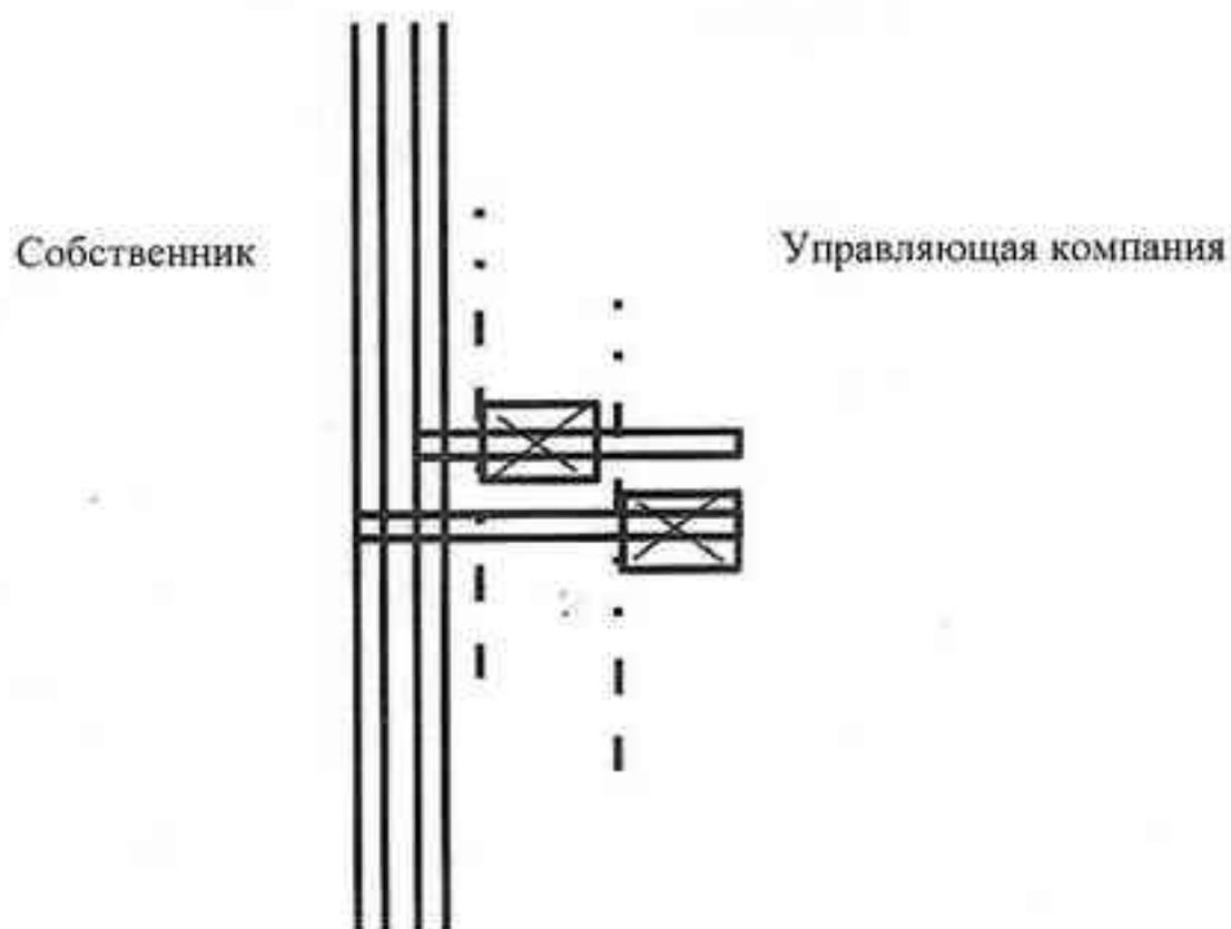
Первые запорно-регулирующие краны на отводах внутриквартирной разводки от транзитного стояка горячего и холодного водоснабжения. Транзитный стояк обслуживает Управляющая компания, систему после точки разделения от первого вентиля на стояке, либо от первого сварного соединения - Собственник.
