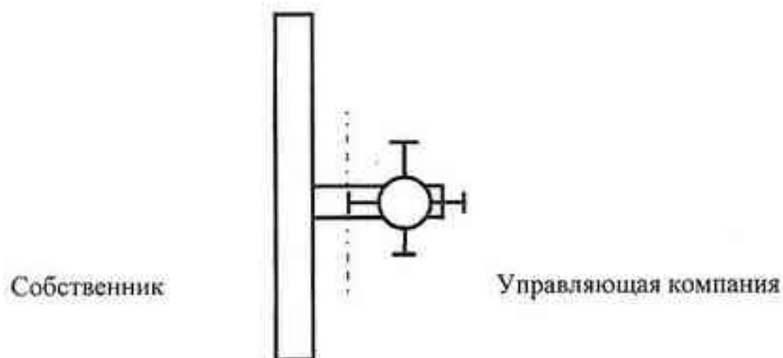
Точка присоединения отводящего трубопровода системы водоотведения к тройнику транзитного стояка общедомовой системы водоотведения. Сам стояк обслуживает Управляющая компания, тройник и остающаяся часть - Собственник.
