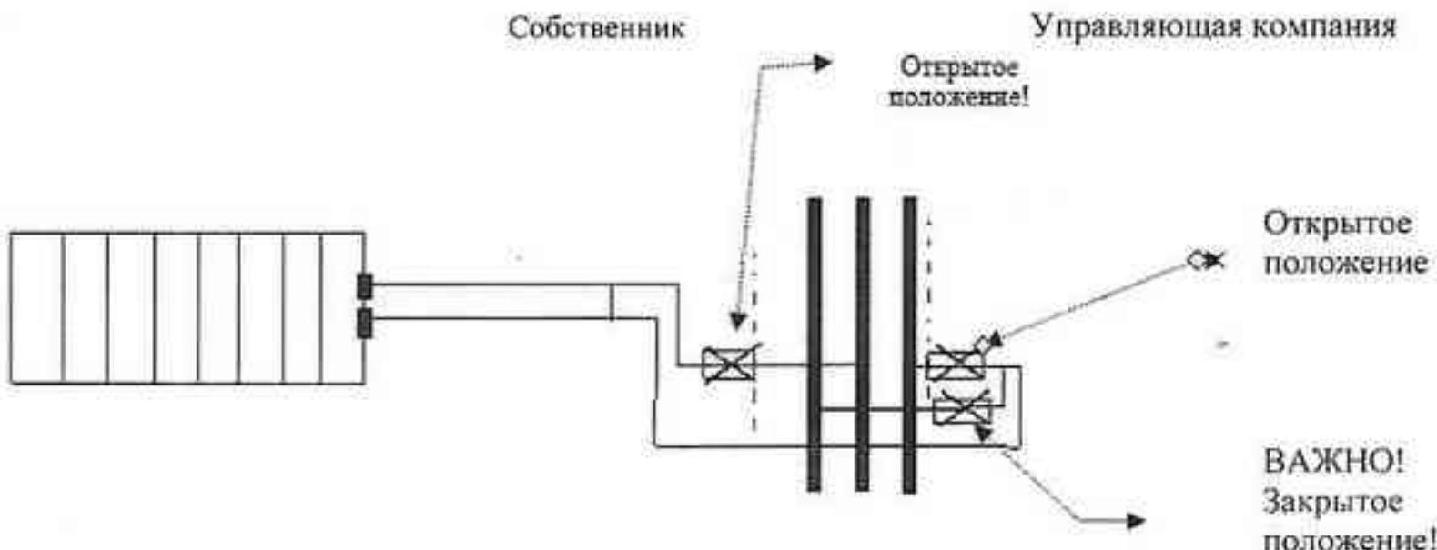
Первые точки присоединения подводящих и отводящих трубопроводов системы отопления. При отсутствии вентиляй - по первым сварным соединениям на стояках. Подводящие и отводящие трубопроводы до точек присоединения обслуживает Управляющая компания, остающуюся часть - Собственник.
