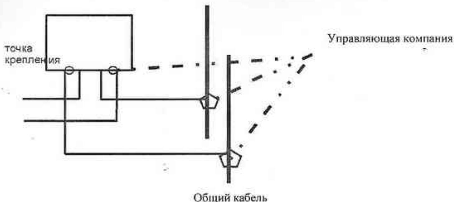
Стойковую разводку (общий кабель) и точки крепления провода обслуживает Управляющая компания. От точек крепления, отходящих к помещению Собственника фазового, нулевого и заземляющего проводов от вводного выключателя и всё электрооборудование обслуживает - Собственник.
