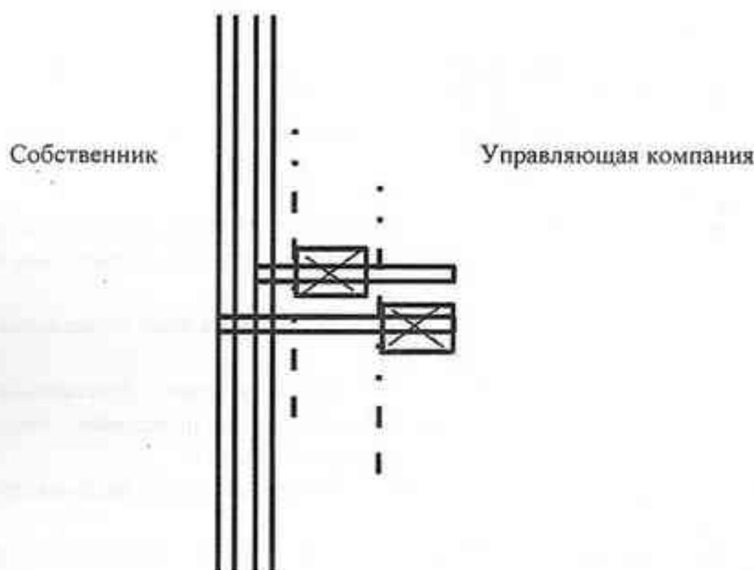
Первые запорно-регулировочные краны на отводах внутриквартирной разводки от транзитного стояка горячего и холодного водоснабжения. Транзитный стояк обслуживает Управляющая компания, систему после точки разделения от первого вентиля на стояке, либо от первого сварного соединения - Собственник.
