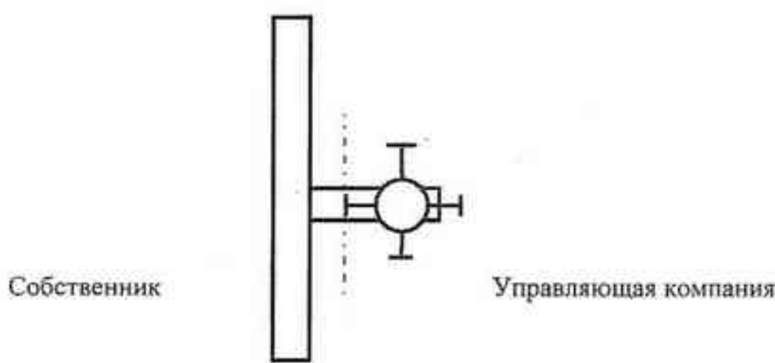
Точка присоединения отводящего трубопровода системы водоотведения к тройнику транзитного стояка общедомовой системы водоотведения. Сам стояк обслуживает Управляющая компания, тройник и остающуюся часть - Собственник.
